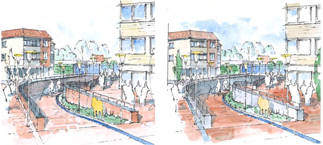
Zeichnerische Gegenüberstellung Seitenwandoberflächen Ziegel (rot) / Beton (grau)
